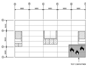
TEST 3 : CORNER COMPARTMENT TEST
